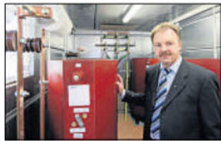
Große Spulen: Mit ihnen simuliert Norbert Henze Kurzschlüsse im Netz.
